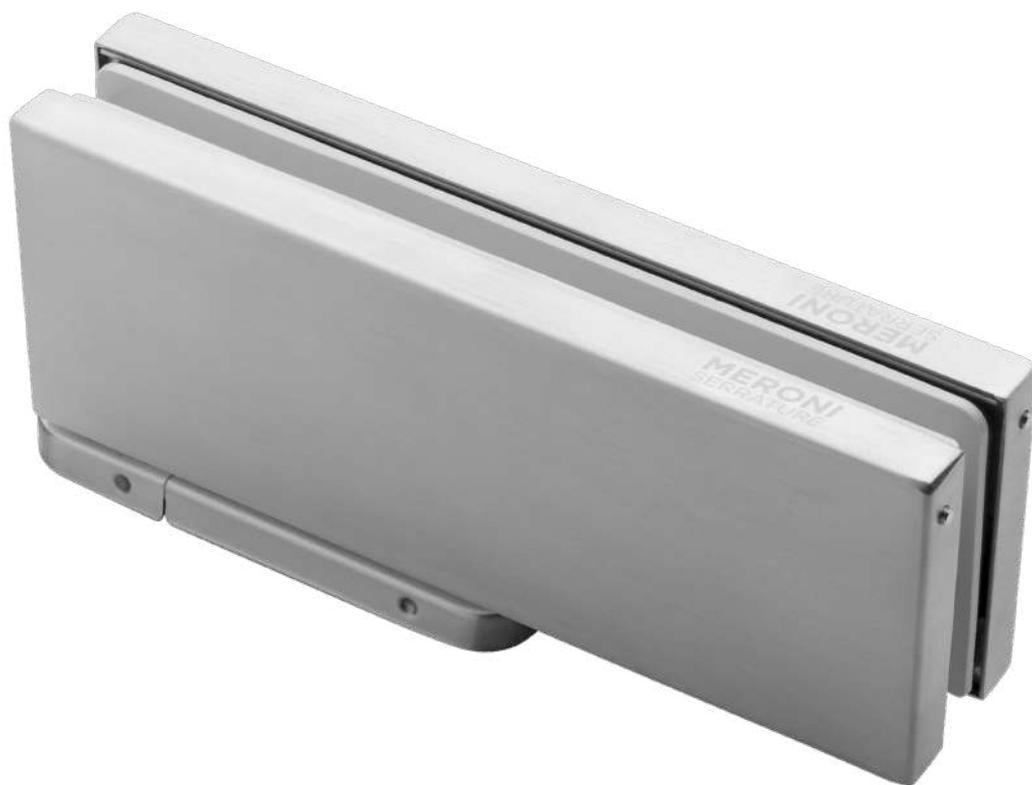
FS880 è un innovativo chiudiporta idraulico a pavimento per porte in vetro. Il sistema di chiusura è integrato all'interno della cerniera bassa e ha le stesse funzionalità dei comuni chiudiporta a pavimento ma, rispetto ad essi, ha il vantaggio di essere meno invasivo e di non richiedere alcuna predisposizione: nessun buco nella pavimentazione o cassetta da cementare, con un notevole risparmio in termini di tempo e costo.
